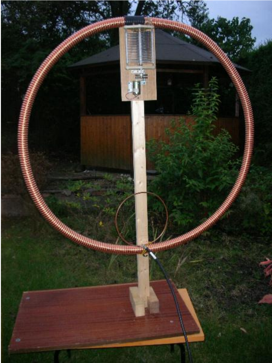
Une loop magnétique fabriquée par Bernard F8AHT.
