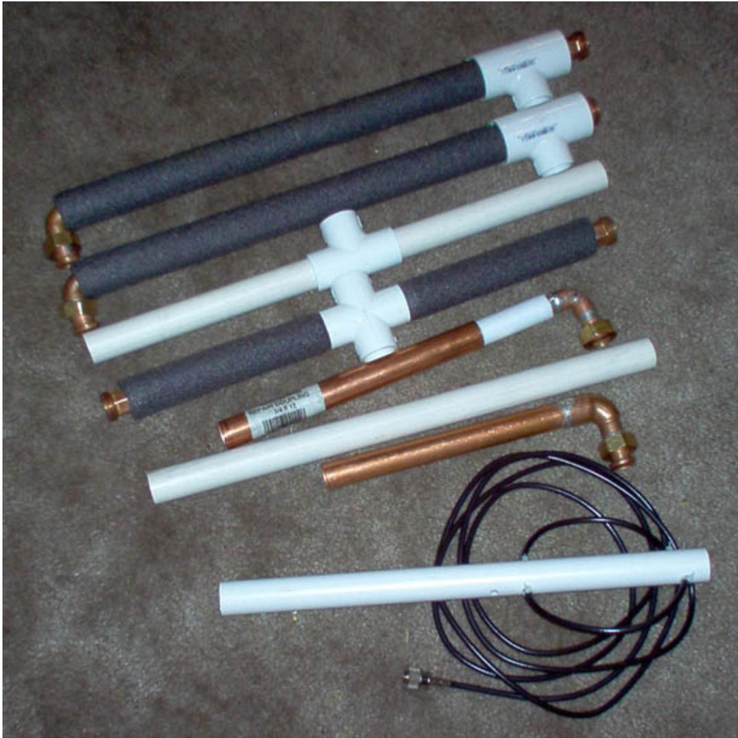
Exceto para o acoplamento laço, que é fabricado a partir de RG-58 coaxial, toda a antena é feita a partir de hardware loja partes.
