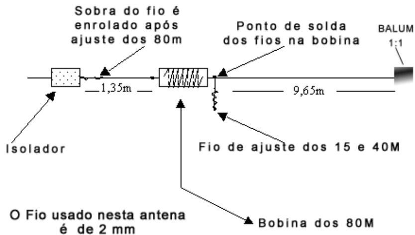
Inclui-se os fios da banda de 10 metros, 2,75 metros de comprimento total, dos quais 25 cm, são usados para ajuste do ROE, conforme figura abaixo:
