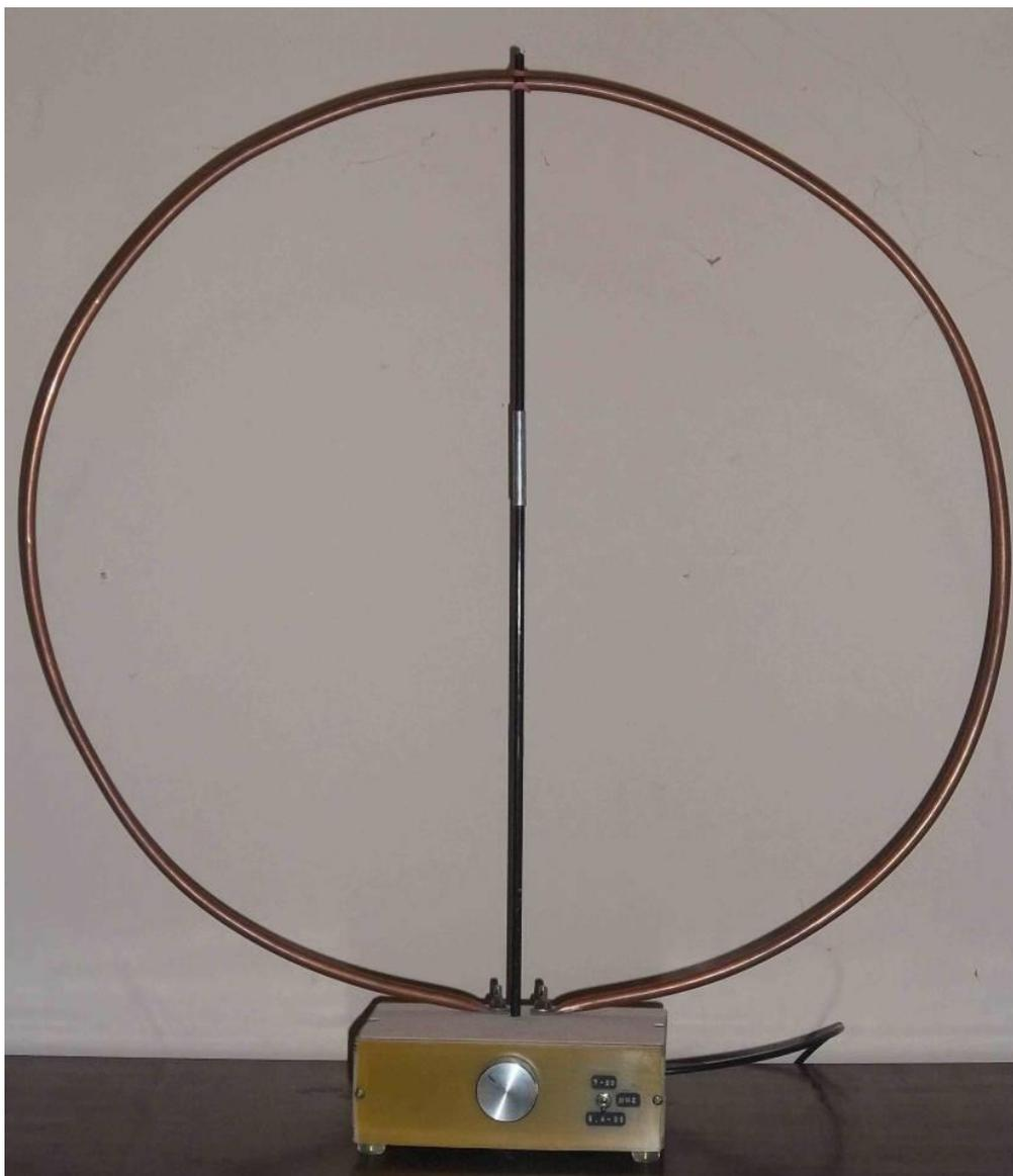
Aqui o Schaltplan. Das de rádio deve ser conectado não diretamente para o loop, mas simplesmente ligue o rádio ao lado dela ou ligar a entrada de antena, através de um enrolamento pequeno do paddock.
