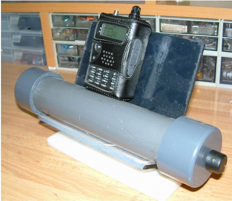
**Al otro lado y con el fin de conectarla a cualquier posible receptor que tenga toma de antena exterior, lleva un conector BNC de chasis. En caso extremo de violencia puede servir como arma arrojadiza, ya que pesa cerca de dos kilos...hi hi.....**
