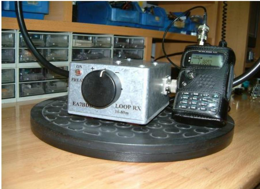
Un engendro que se me ocurrió al ver en una web un montón de ferritas de unas 20 apiladas con dos bobinados y un condensador musiquero de transistor que actuaba como una antena inductiva sobre la barra de ferrita de cualquier transistor, aprovechando que el F-7 lleva uno pues me dije, voy a ver que tal sale y ! que alegría le entra cuando se acerca el uno al otro ! hi hi.....solo para entusiastas de OM...
